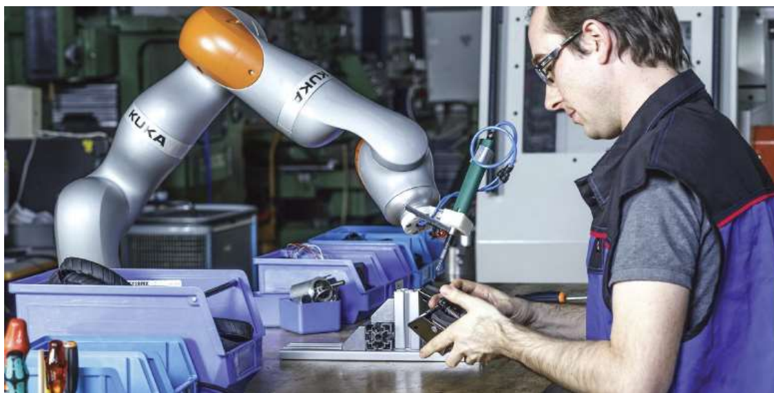
Kooperující průmyslový robot. Jeho čidla zamezí poranění pracovníka v případě kolizních situací.
