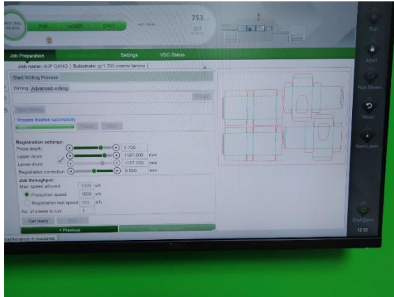
Obrazovka na programování výseku a bigování, kde se vytvoří celý produkt.
