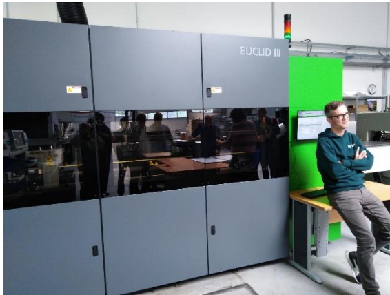
Digitální stroj na výšek laserem a bigování
